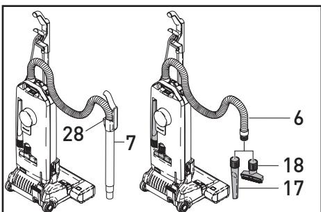
Pour utiliser le tube accessoire (7) ou le flexible (6) mettre la machine en position verticale, puis soulever le tube de la machine et allonger le flexible jusqu'à ce qu'il se verrouille. Lorsque le tube est retourné dans son rangement, assurez-vous qu'il est bien emboîté dans sa position de rangement (35).
