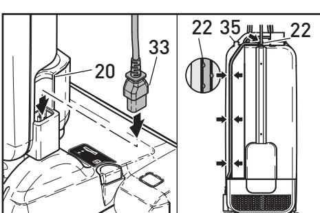
De stekker(33)van de aansluiteiding bij het scharniergewicht(21) inpluggen,hierbij goed opletten dat de stekker achter kant (20) wordt gehouden. Aansluitend de leiding aan de binenzijde van de bevestigings (22)plaats van de telescoopbuis plaatsen.
