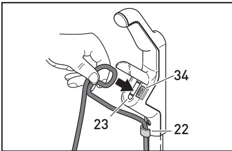
Finalement insérer le câble dans le taquet bloquant (23). Vous pouvez entendre un « clic » lorsque le câble d'alimentation est complètement inséré. Pour enlever le câble d'alimentation, pousser le bouton (34) qui se trouve à côté du taquet bloquant (23) et retirer le câble.
